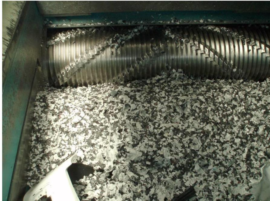
*Foto: Triturador con Paragolpes de Polipropileno.*
