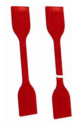
*Foto: ejemplo de Probetas para ensayos.*
